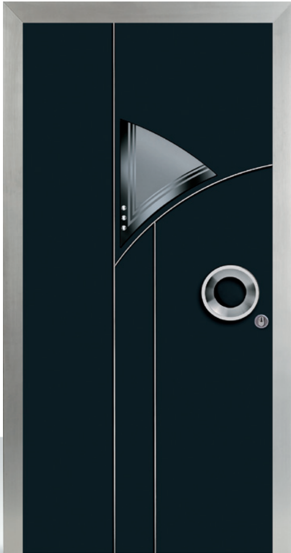
Modell 4123 Material: Aluminium Oberfläche: Rahmen in Weißaluminium, Türblatt in Anthrazitgrau RAL 7016 Ausführung: Einseitig (außen) flügelüberdeckend Verglasung: Unikatverglasung, Klarglas mit Teilmattierung und Swarovski-Steinen Beschlag: Edelstahlgriff poliert und satiniert, Rosette außen rund
