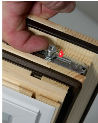
SICHERHEITS-PILZZAPFEN Automatische Höheneinstellung zum Falzluftausgleich bzw. durch Handeinstellung + 2,5 mm
