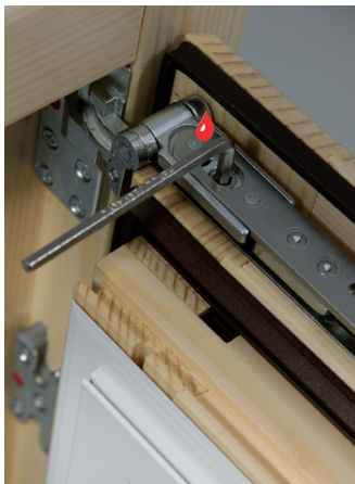
Seitenverstellung oben +/- 2 mm
