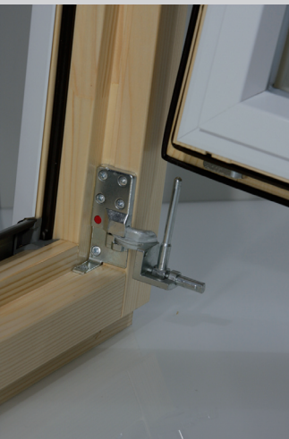
1. Sicherheits-Tresorband unten in 90° Stellung drehen und Achsstift bis zu Anschlag neigen
