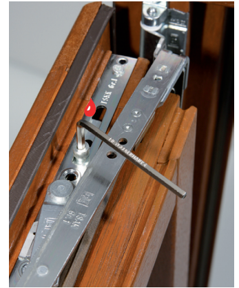
Flügelandruckeinstellung an der Schere oben +/- 1 mm
