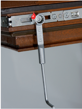
SICHERHEITS-PILZZAPFEN Flügelandruckeinstellung (SW 11) +/- 1 mm
