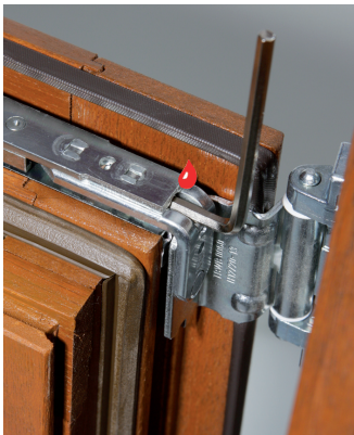
Seitenverstellung oben +/- 2 mm
