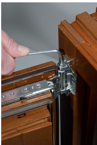
3. Scherenlager oben, Sicherungsbolzen nach unten entfernen (mit Inbusschlüssel 4 mm)
